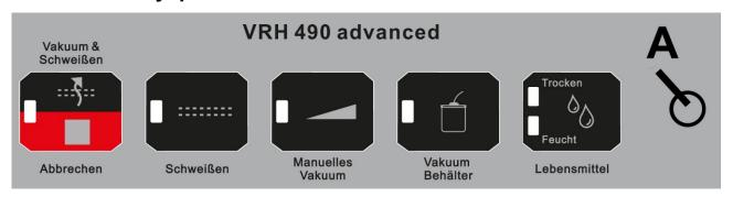
**Кнопки** (выбранная функция отображается соотвутствующим световым индикатором)
